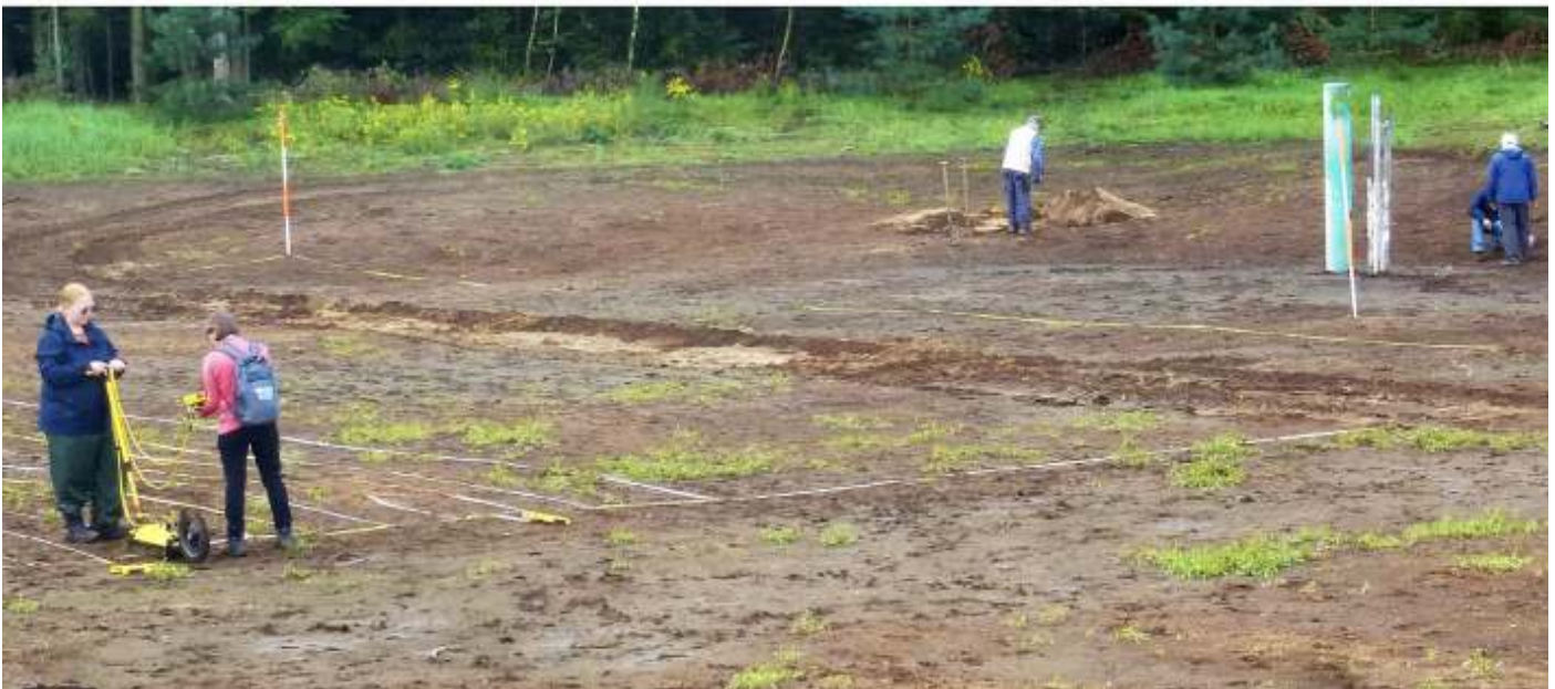
Links Janneke en Dominique met de grondradar, die langs de uitgezette lijnen wordt getrokken...
